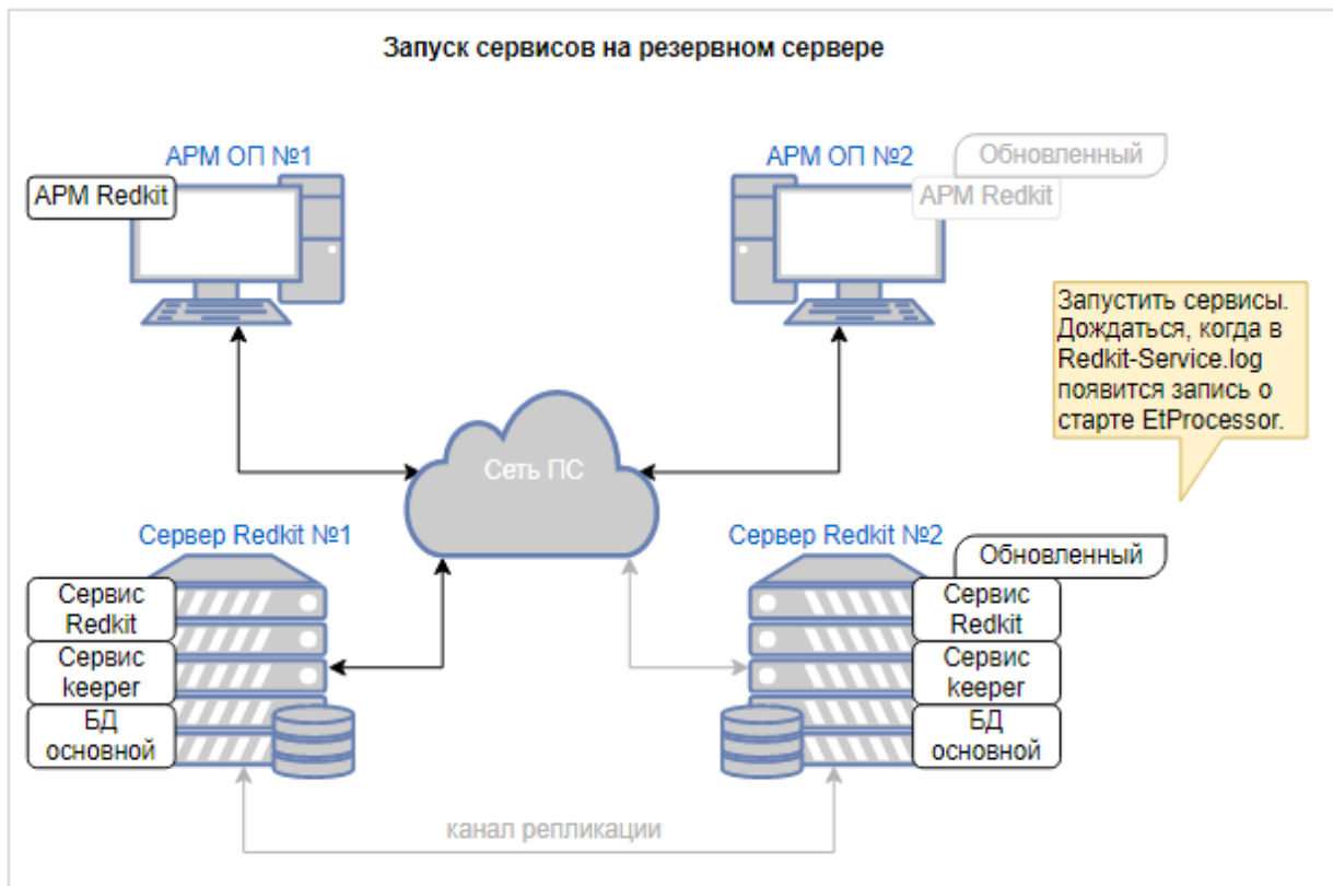
Рисунок 481 - Запуск сервисов на резервном сервере
